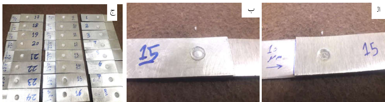
شکل ۴- اتصال سمت منیزیم (الف) سمت فولاد (ب) نمونه‌های نقطه جوش مقاومتی (ج).
