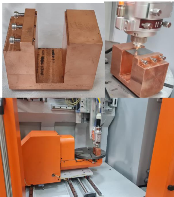
شکل ۴- محل قرارگیری نمونه در دستگاه سوراخ کاری لیزری.
