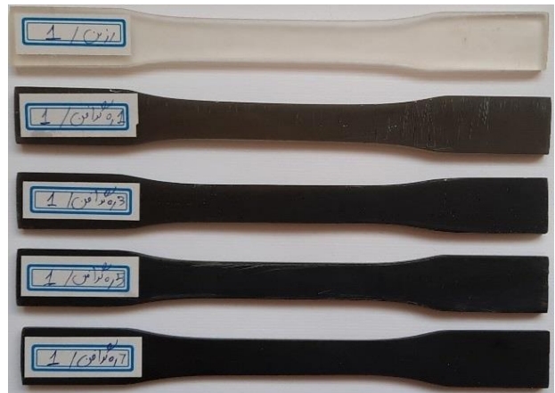
شکل ۴- نمونه‌های نانوکامپوزیتی آماده شده برای آزمون کشش تک‌محوری، حاوی درصد‌های وزنی مختلف نانواکسید گرافن. نمونه رزین خالص با رنگ روشن قابل مشاهده است.
