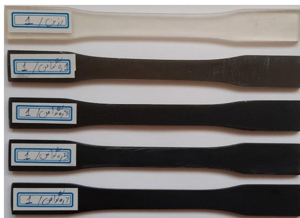
شکل ۴- نمونه‌های نانوکامپوزیتی آماده شده برای آزمون کشش تک‌محوری، حاوی درصد‌های وزنی مختلف نانو اکسید گرافن. نمونه رزین خالص با رنگ روشن قابل مشاهده است.
