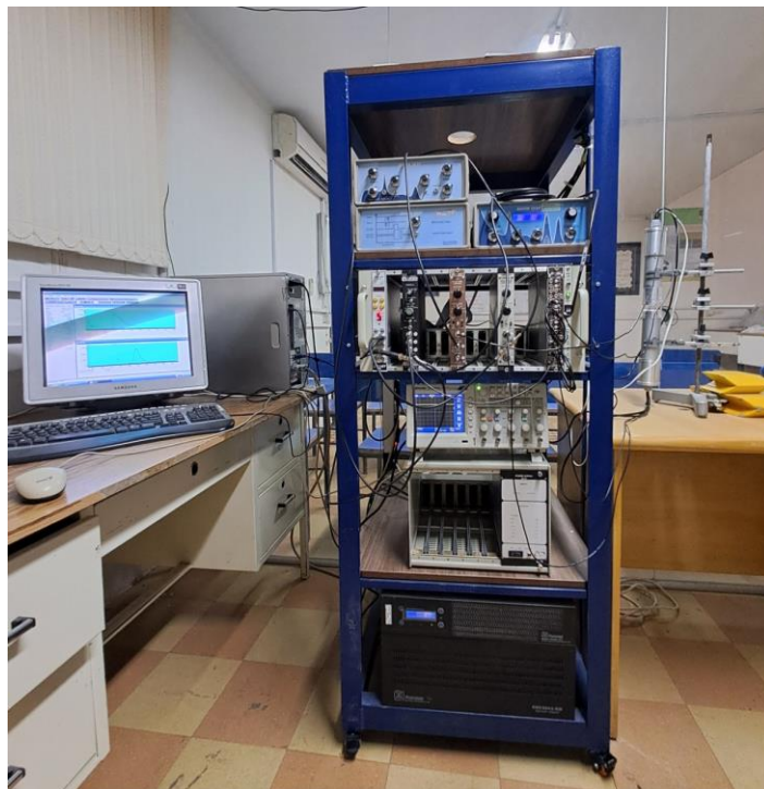
شکل ۳- تصویری از چیدمان آزمایشگاهی سامانه طیف‌سنجی طول عمر نابودی پوزیترون.
