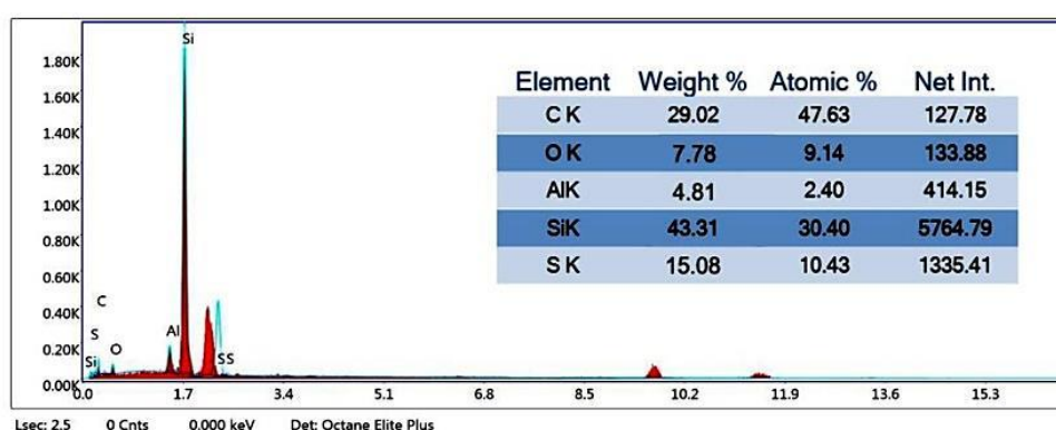
شکل ۱۴- نتایج آزمون طیف‌سنجی تفکیک انرژی از نقاط سفیدرنگ سطح سایش نمونه‌های MCMB-C/SiC تفجوشی‌شده به‌روش SPS با دو درصد ریزدانه‌های مزوفاز کربنی: الف) با ۱٪ درصد MCMB و ب) با ۱ درصد MCMB.
