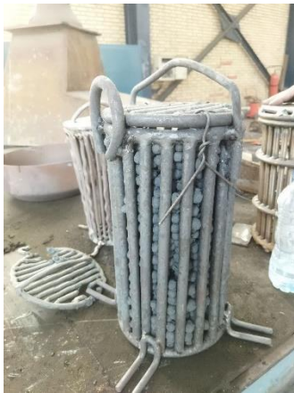
شکل ۴- بسکت ساخته شده از جنس فولاد زنگ‌نزن ۳۱۴ به همراه گندلهای تولیدی.
