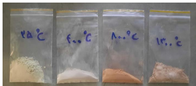
شکل ۸- تصاویر از نمونه‌های بنتونیت خام و عملیات حرارتی شده در دماهای مختلف.
