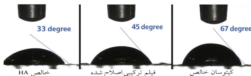
شکل ۷- تصویر زاویه تماس قطره مایع با سطح سه فیلم پلیمری ترکیبی پیوند عرضی شده، هیالورونیک اسید و کیتوسان.
