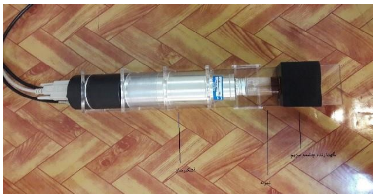
شکل ۴- چشمه سزیم که در داخل مکعب قرار داده شده است، ژل پلیمر حاوی نانوذرات نقره در غلظت یک میلی مولار و در ارتفاع یک سانتی متر و آشکارساز NaI(TL).
