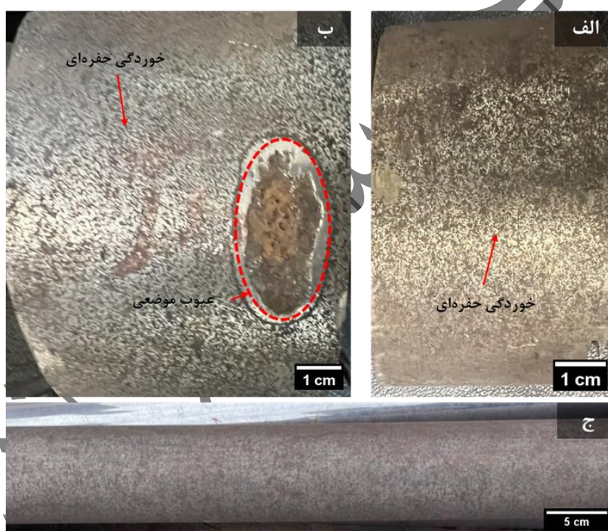
شکل ۵- نمونه برش داده شده از جنس فولاد ۱.۴۳۱۳. (الف) نمونه دارای خوردگی حفره‌ای که به صورت همگن روی سطح مشخص شده است، (ب) نمونه دارای خوردگی حفره‌ای رخ داده بر سطح و عیب موضعی ناشی از بهره‌برداری، (ج) وقوع خوردگی به صورت همگن در سرتاسر قطعه مورد بررسی.
