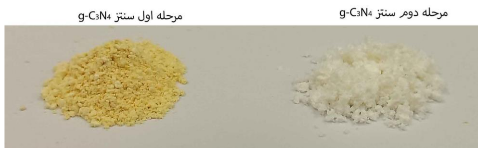
شکل ۱- طرحواره مراحل سنتز نانوصفحات g-C_3N_4 دوپ شده با گوگرد (S-CN).
