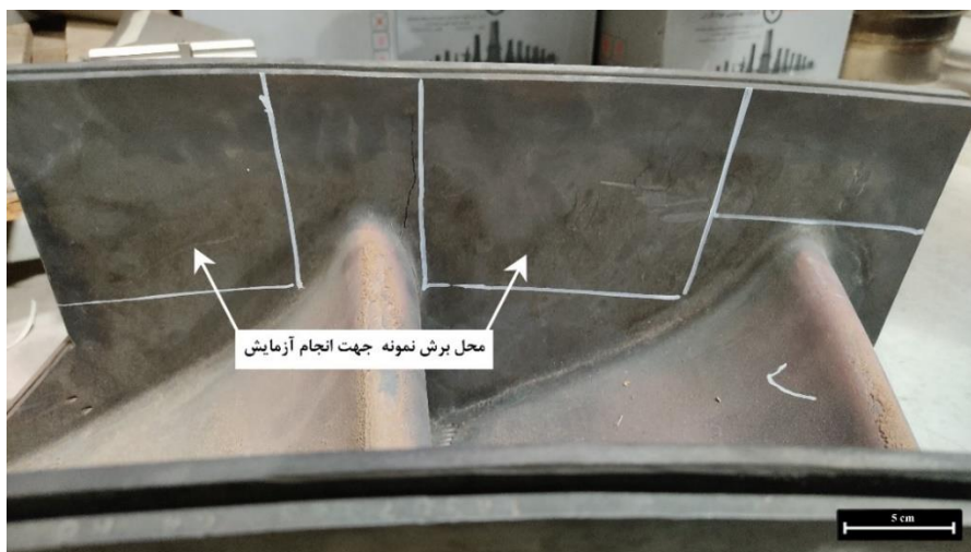
شکل ۱- برشکاری قطعات برای جوشکاری GTAW از دیواره نازل ۶۶۰۰۰ ساعت تحت سرویس.
