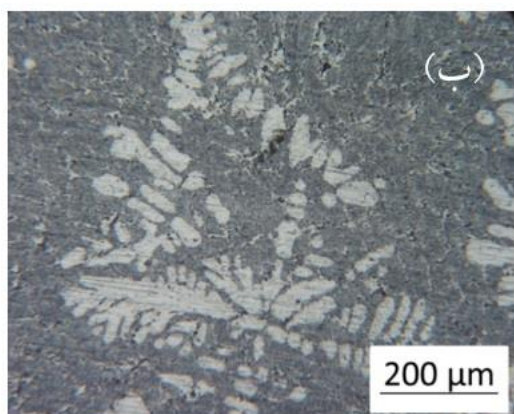
شکل ۱- (الف) طیف EDX و (ب) تصویر ریزساختار از مقطع پایینی شمش اولیه Al-13.8%Mg 2 Si ریخته‌گری شده به روش ثقلی.
