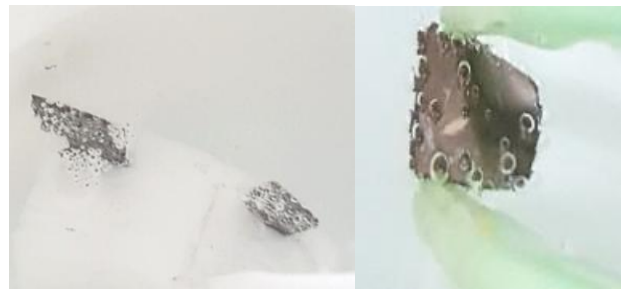
شکل ۴- حباب‌های هیدروژن تولید شده در حین فرایند زدایش سیلیکون در محلول نیترات مس، هیدروفلوئوریک اسید و آب اکسیژنه (رنگی در نسخه الکترونیکی)
