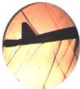
شکل ۳-ح) حرکت موج ناپایا روی بخش انتهای مدل با دم عمودی دوتایی، \alpha=6^\circ
