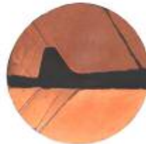
شکل ۳-ج) موج ناپایا روی بخش انتهای مدل با یک دم عمودی، \alpha=0^\circ
