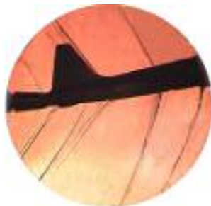
شکل ۳-د) موج ناپایا روی بخش انتهای مدل با یک دم عمودی، \alpha=6^\circ
