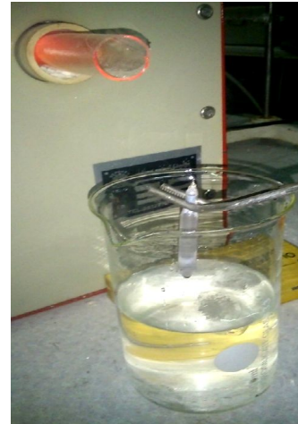
شکل ۱- نحوه سرد سازی نمونه های بازپخت شده در مخلوط آب و یخ
