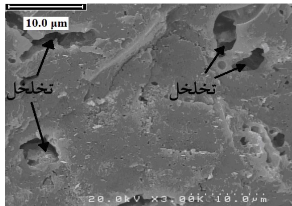
شکل ۷- تصویر میکروسکوپی الکترونی روبشی ریزساختار نانوکامپوزیت آلومینا-کاربید سیلیسیم اتصال مولایتی حاوی ۱ درصد وزنی نانوتیتانیا
