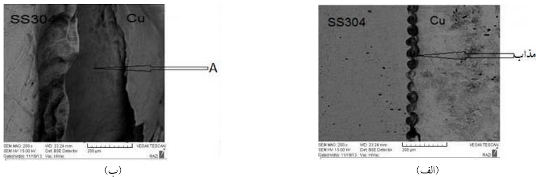
شکل ۱۱- تصاویر میکروسکوپی الکترونی روبشی آزمون سه: الف) فصل مشترک و ب) منطقه ذوب موضعی A
