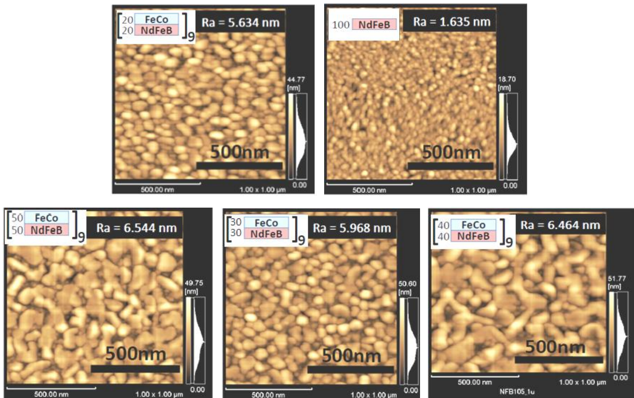
شکل ۵- تصاویر میکروسکوپی نیروی اتمی لایه چندگانه در ضخامت‌های مختلف لایه نرم و سخت
